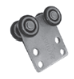
CC-20L c/t carro con gancho para cortinas (25 Kg. ud.) con topes banda de rodadura en poliamida.
